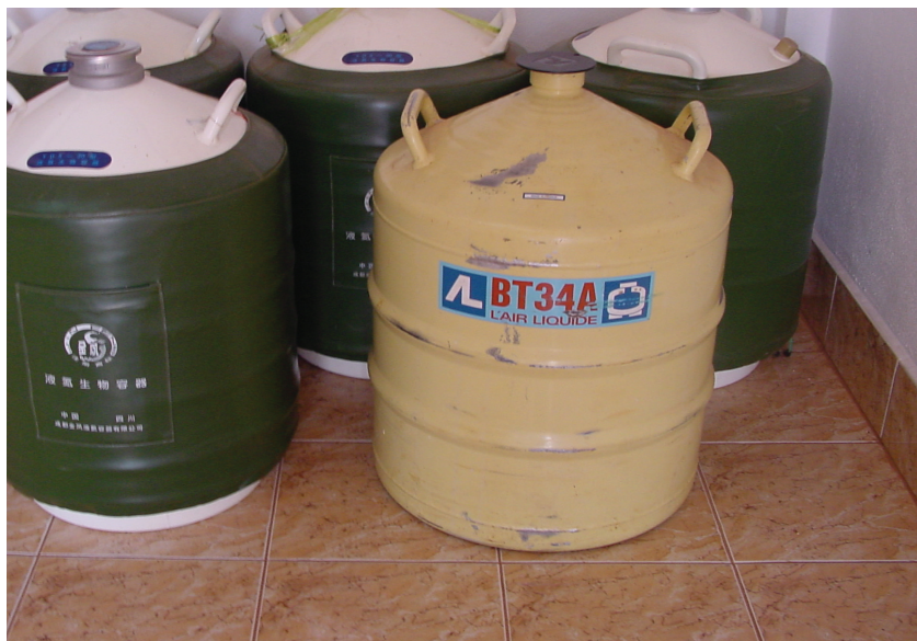
ຮູບ 4: ຖົງເກັບນ້ຳເຊື້ອຢູ່ຫ້ອງທົດລອງ ຂະໜາດບັນຈຸ 30 ລິດ
